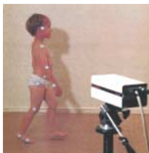
Fig. 4 - I marker vengono solitamente applicati al soggetto in punti che coincidano con articolazioni o parti terminali dei segmenti
