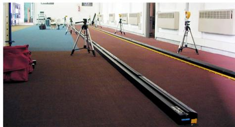
**OptoJump** per installazioni fisse è fornito in un robusto contenitore in alluminio, della lunghezza di 3 metri, contenente anche il sistema di alimentazione. È sufficiente posizionare le barre a terra, collegarle l'un all'altra tramite il sistema d'aggancio rapido ed in pochi minuti si può attrezzare una pista di test lunga anche fino 100 metri. La robustezza del sistema lo rende idoneo per installazioni fisse al coperto.
