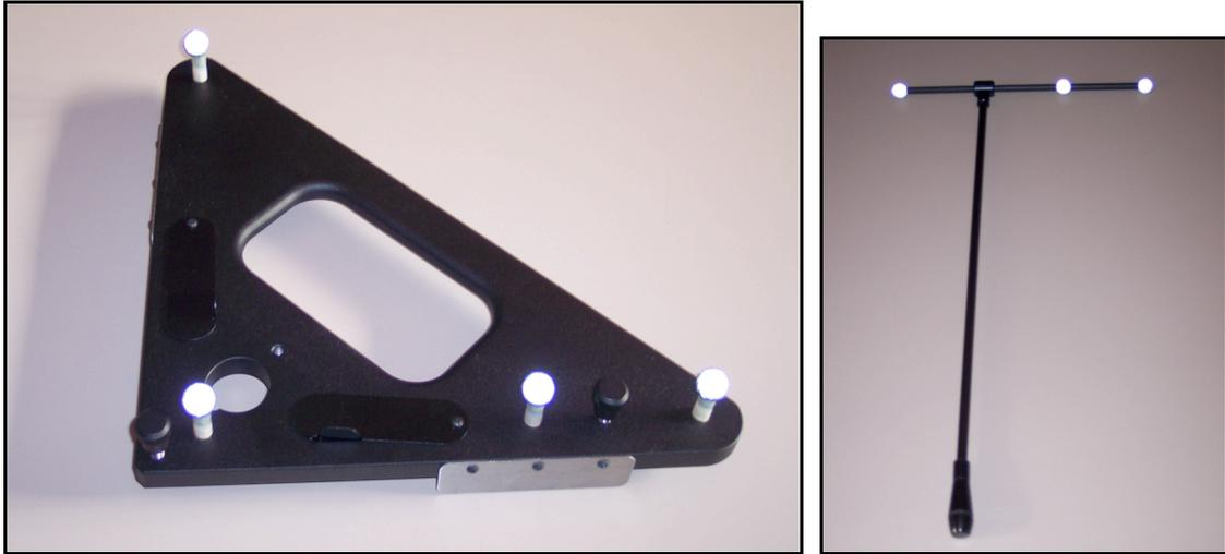
Figura 1.3: L-Frame ed asta Wand (240 mm) usata nella fase di calibrazione dinamica.
